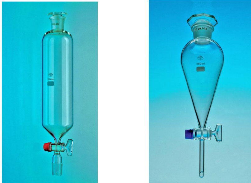
Рис. 1.8. Розподільчі (ділильні) лійки
