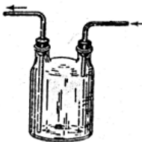
Рис. 1.29. Запобіжна склянка до водоструменевого насоса
