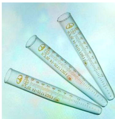
Рис. 1.1. Проста та градуйована пробірки
