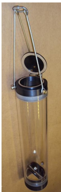
Мал. 3. Прилад для відбору вод придонного шару.
