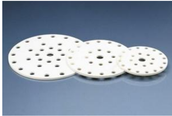
Рис. 1.44. Фарфорові вкладки в ексикатор
