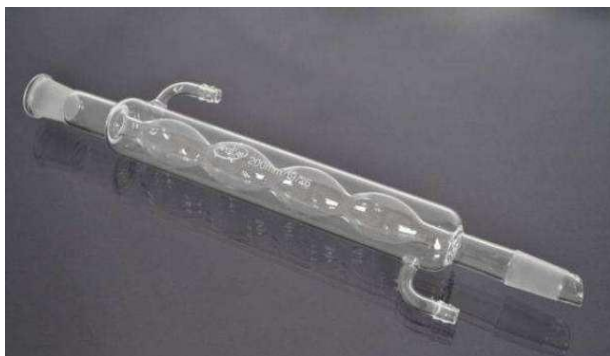
Рис. 1.23. Зворотні холодильники: а – кульковий (Алліна), б – змієвиковий
