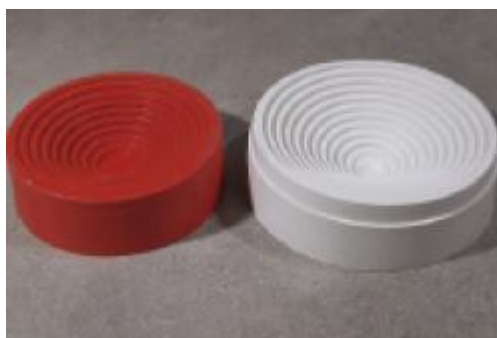
Рис. 1.35. Підставка для круглодонних колб
