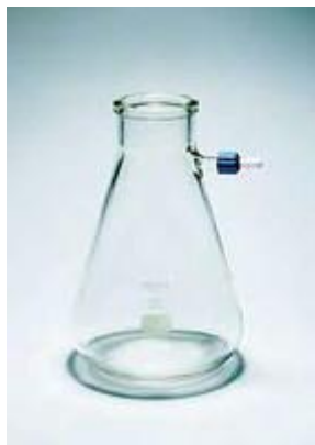
Рис. 1.18. Колба для фільтрування під вакуумом (Бунзена)
