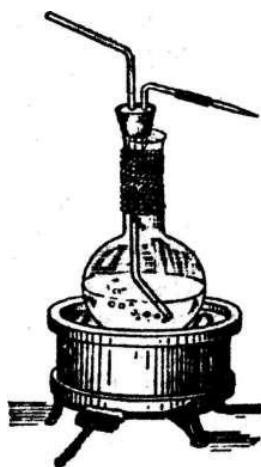
Рис. 1.16. Нагрівання води в промивалці
