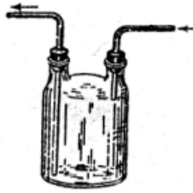
Рис. 1.29. Запобіжна склянка до водоструменевого насоса
