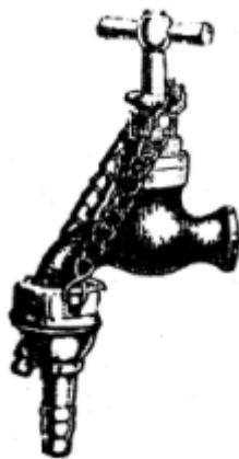
Рис. 1.28. Насадка для прикріплення водоструменевого насоса до водопровідного крана
