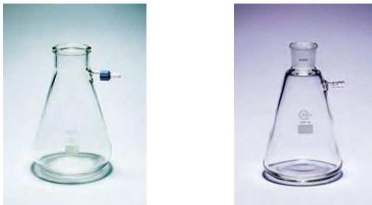
Рис. 1.18. Колба для фільтрування під вакуумом (Бунзена)
