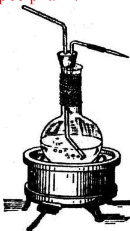
Рис. 1.16. Нагрівання води в промивалці
