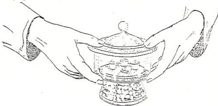
Рис. 1.45. Положення рук під час перенесення ексикатора
