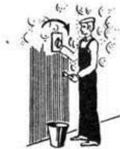
Рис. 3 . Організація робочого місця штукатурка за затирання штукатурки
